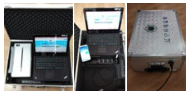
开箱即执法 箱内配备插排和 USB 接口 箱体配备电源接口 图 2-6
